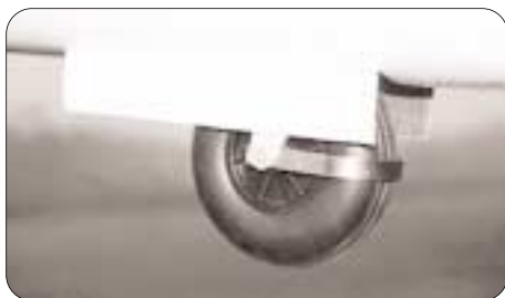
Die Klappen des Fahrwerkschachtes wurden komplett mit Kohlefaserewebe verstärkt (links). So erhalten sie eine hervorragende Stabilität.
