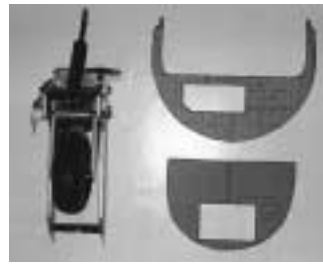
Die Pappschablonen für die Spanten, die später das Einziehfahrwerk aufnehmen, werden nach dem Anzeichnen der genauen Position an die Rumpfkontur angepasst. Oben die fertigen Schablonen, die nun noch auf das Holz zu übertragen sind.
