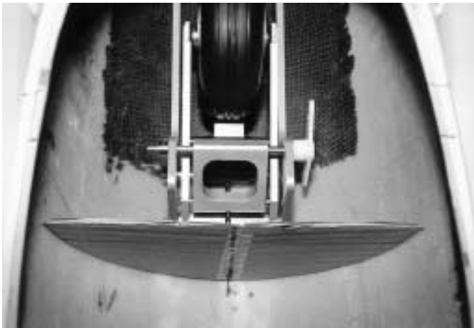
Die Pappschablonen für die Spanten, die später das Einziehfahrwerk aufnehmen, werden nach dem Anzeichnen der genauen Position an die Rumpfkontur angepasst. Oben die fertigen Schablonen, die nun noch auf das Holz zu übertragen sind.
